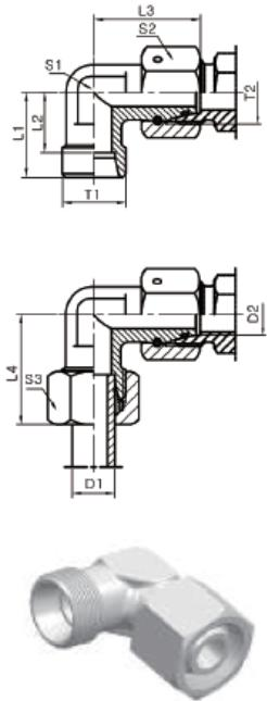
**90°弯外螺纹内螺纹转换接头**
