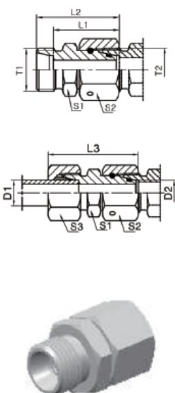
外螺纹内螺纹转换接头
