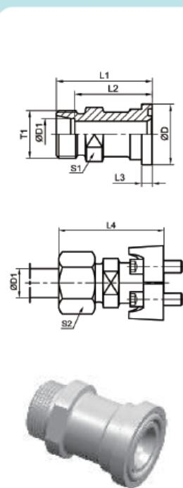
DIN卡套式/SAE法兰
