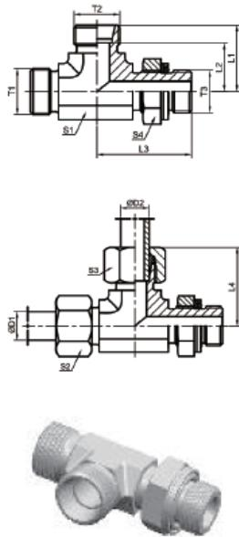
公制外螺纹可调向柱端 ISO 6149 主支三通
