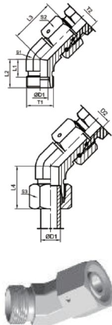
**45°弯外螺纹内螺纹转换接头**
