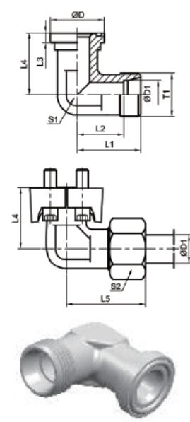
90 °弯DIN卡套式/SAE法兰
