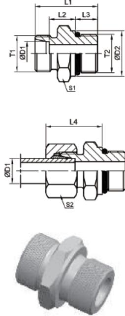
管螺纹O型圈密封柱端 ISO 11926
