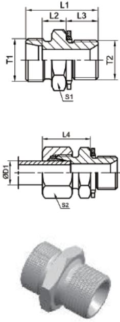
英管螺纹60°密封或组合垫密封两用柱端
