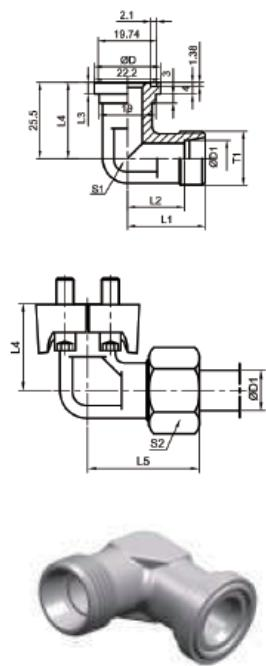
90 °弯DIN卡套式/SAE法兰
