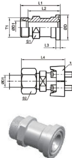
DIN卡套式/SAE法兰
